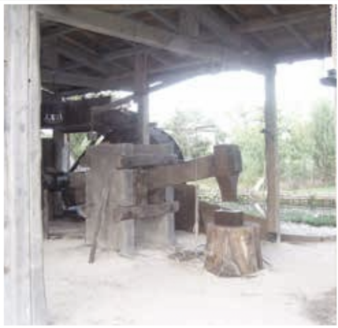
Riproduzione di un maglio, con albero a camme, per la lavorazione del ferro. Foto di A. Barlucchi
