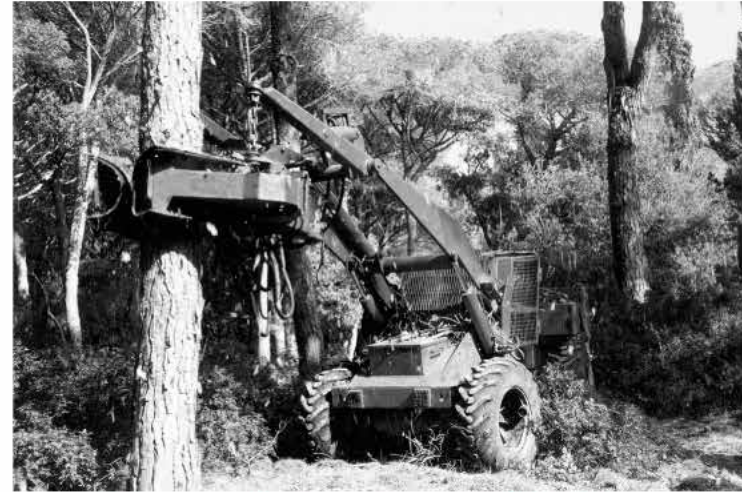
La scuotitrice con moderni mezzi meccanici. Ditta "Lavorazione pinoli di Lanini Edo & C."
